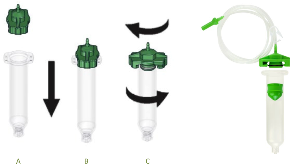
Rysunek 6: Montaż adaptera do strzykawki.
