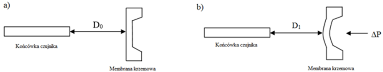
Rysunek 1. Pomiar ugięcia membrany, gdzie: a) D_0 to odległość do powierzchni membrany zmierzona przy ciśnieniu względnym 0 kPa, b) D_1 to odległość zmierzona dla ciśnienia względnego > 0 kPa.
