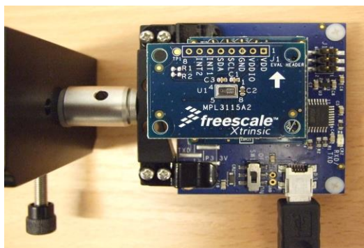
Rys. 1. Widok makiety dydaktycznej wysokościomierza barometrycznego
