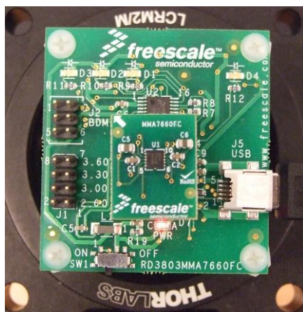
Rys. 1. Makiety edukacyjne przyspieszeniemia trójosiowego (a) i elektronicznego kompasu (b)
