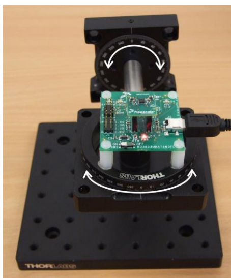
Rys. 2. Makieta dydaktyczna z przyspieszeniemia MMA7660FC – możliwe kierunki obrotu modułu przyspieszeniemia
